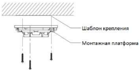
Рисунок 2-26 Установка монтажной платформы
