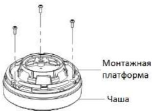
Рисунок 2-40 Установка монтажной платформы
