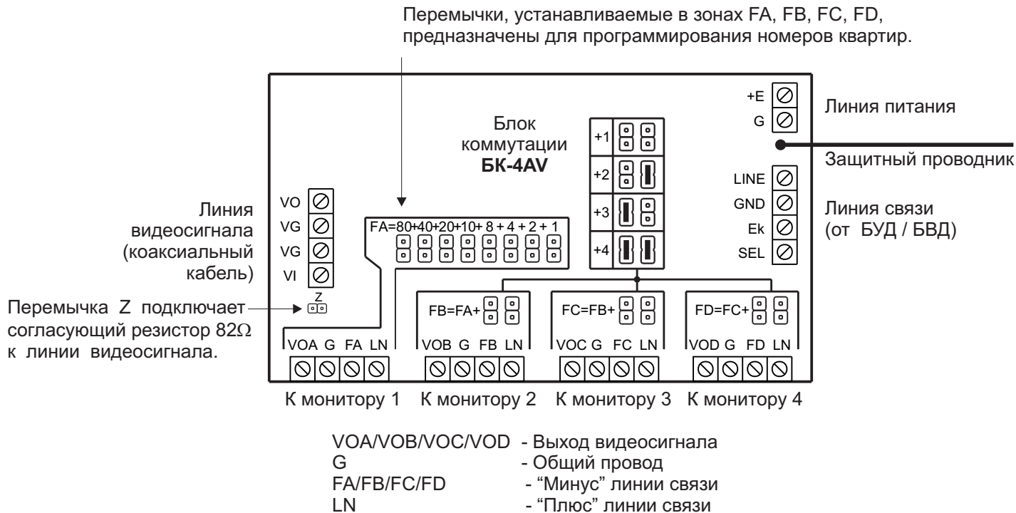
Рисунок 3 - Расположение клемм, назначение цепей и переключателей
