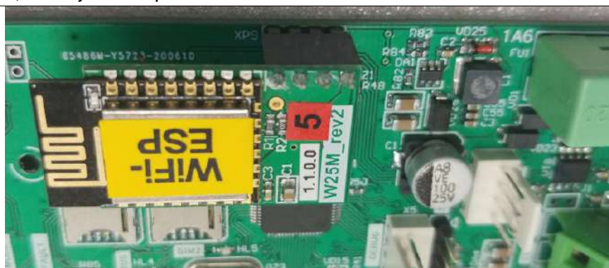
Рисунок 8. Установка WiFi модуля
