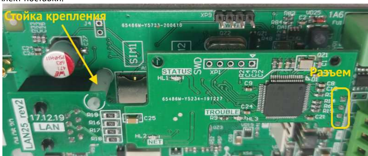
Рисунок 9. Установка модуля коммуникатора LanCom25
