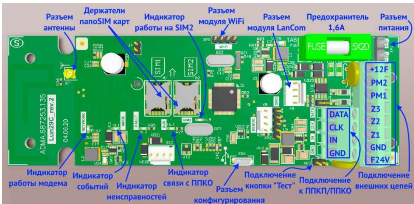
Рисунок 2. Внешний вид и конструкция платы УСО
