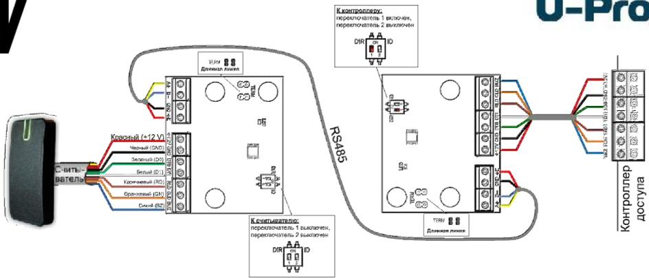
При большой длине шины RS485 возможно значительное падение напряжения в цепи питания. В этом случае следует увеличить сечения проводов питания, либо установить отдельный источник питания непосредственно возле преобразователя на выносе.
