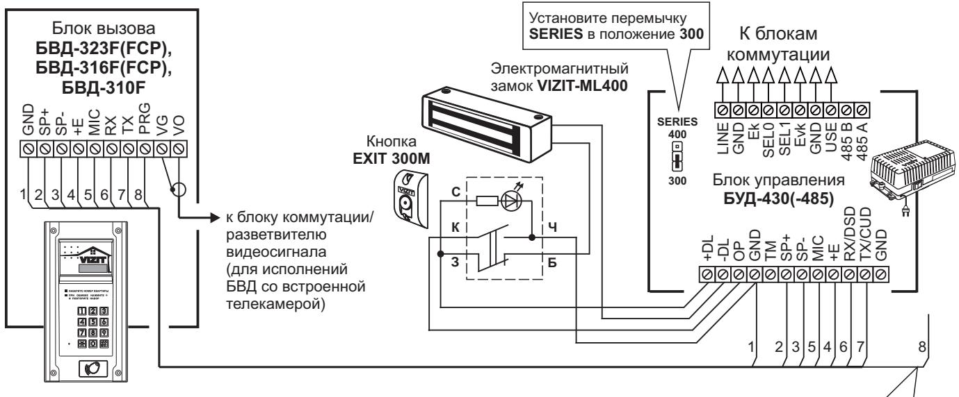
**Примечание.** Подключите провод PRG к клемме GND блока управления при записи МАСТЕР-ключа №1 блока вызова. Отключите провод после окончания записи МАСТЕР-ключа.
