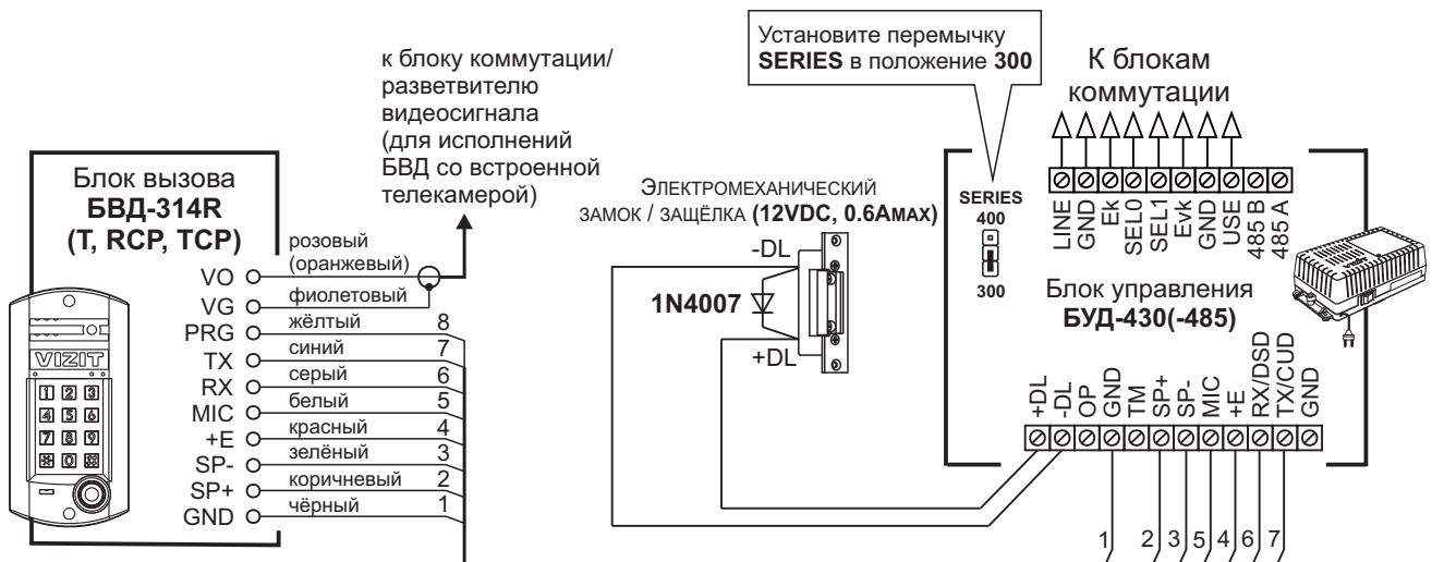
Если электромеханический замок / защёлка не содержит встроенный защитный диод, то между клеммами замка / защёлки следует установить диод, как показано на схеме
