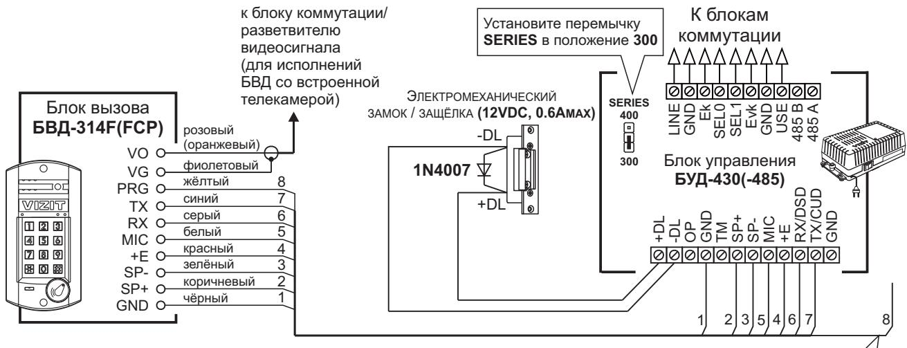
**Примечание.** Подключите провод PRG к клемме GND блока управления при записи МАСТЕР-ключа №1 блока вызова. Отключите провод после окончания записи МАСТЕР-ключа.
