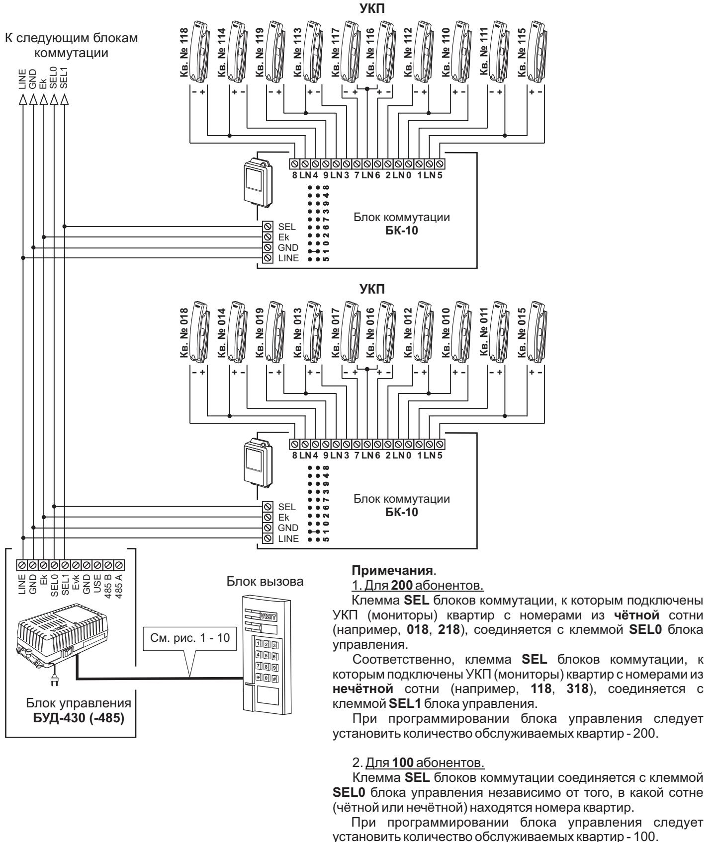
Рисунок 12 - Схема соединений блока управления **БУД-430 (-485)** с блоком коммутации **БК-10** и УКП в составе многоквартирного домофона до 200 абонентов
