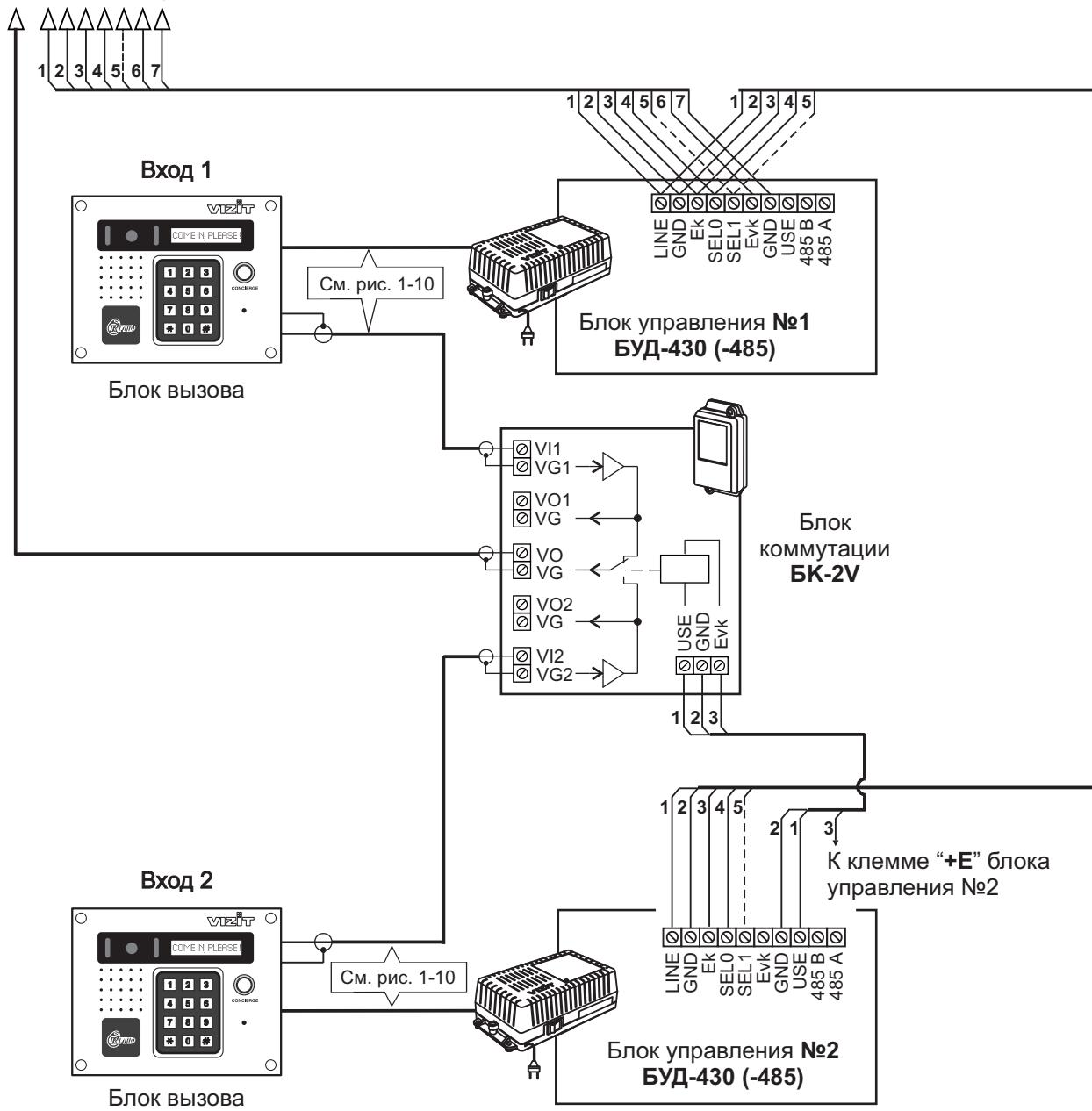
Рисунок 21 - Схема соединений двух блоков управления БУД-430 (-485)
