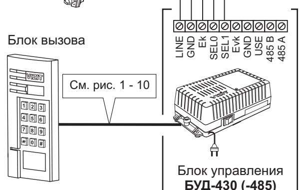
Рисунок 13 - Схема соединений блока управления **БУД-430 (-485)** с блоком коммутации **БК-30М** и УКП в составе многоквартирного домофона до 200 абонентов
