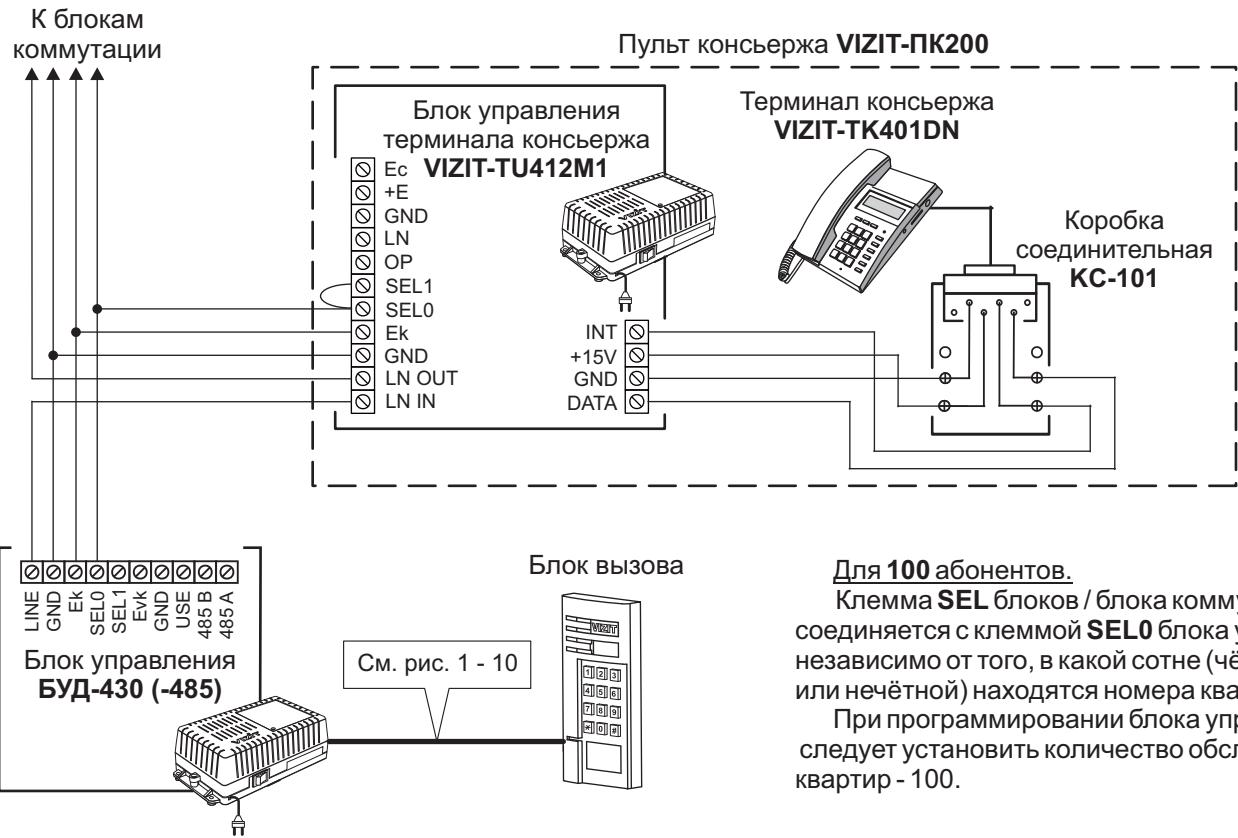
Рисунок 15 - Схема соединений блока управления **БУД-430 (-485)** с пультом консьержа **VIZIT-ПК200** в составе многоквартирного домофона до 100 абонентов
