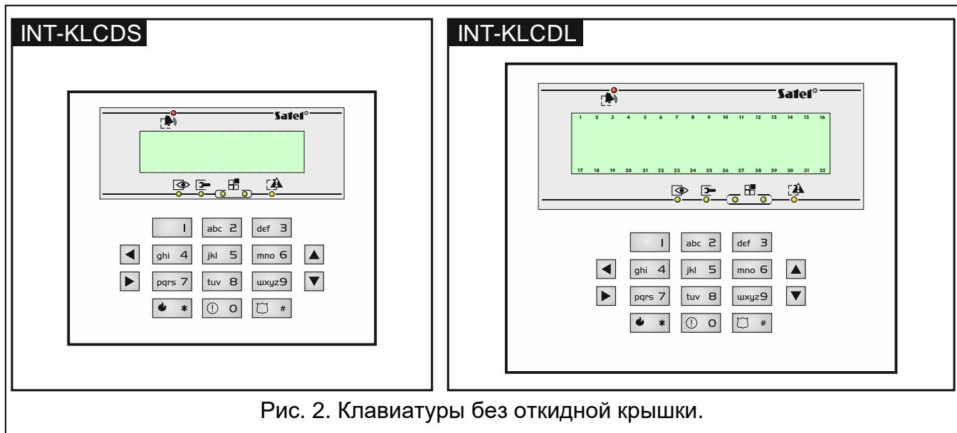
Рис. 2. Клавиатуры без откидной крышки.
