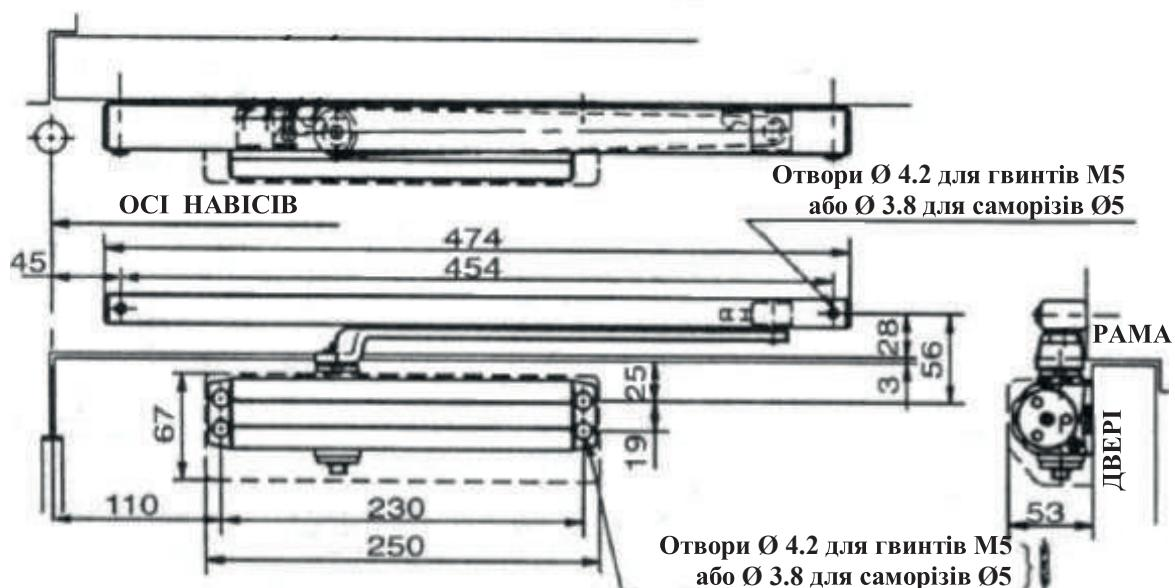
**A** Приєднати основну тягу до дотягувача під кутом 45° від поверхні дверей. Встановити дотягувач на двері короткою стороною вбік навісів.
