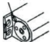
**ПОПЕРЕДЖЕННЯ:** будьте уважні при регулюванні – зайве викручування гвинта проти годинника може привести до його повного викручування та витікання рідини з дотягувача.
