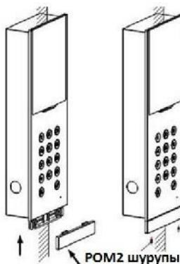
Рисунок 5-11 Закрепление вызывной панели
