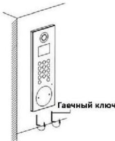
Рисунок 5-5 Затягивание винтов вызывной панели
