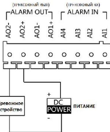
Рисунок 5-26 Подключение выходов тревожных устройств для DS-KD8102-V/DS-KD8002-VM
