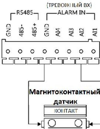
Рисунок 5-19 Подключение магнитоконтактного датчика для модели DS-KD6002-VM
