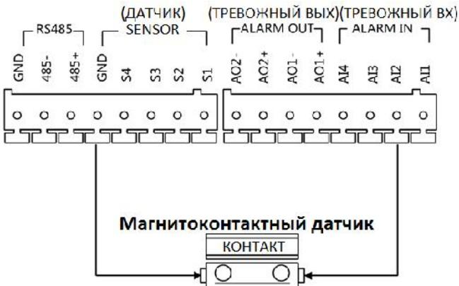
Рисунок 5-17 Подключение магнитоконтактного датчика для моделей DS-KD8102-V/DS-KD8002-VM (1)
