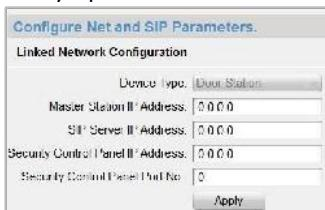
Рисунок 8-37 Меню сетевой конфигурации связанных устройств
