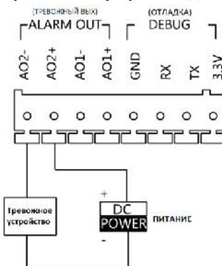
Рисунок 5-27 Подключение выходов тревожных устройств для DS-KD6002-VM
