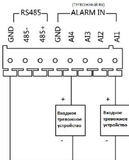
Рисунок 5-25 Подключение входных тревожных устройств для DS-KD6002-VM
