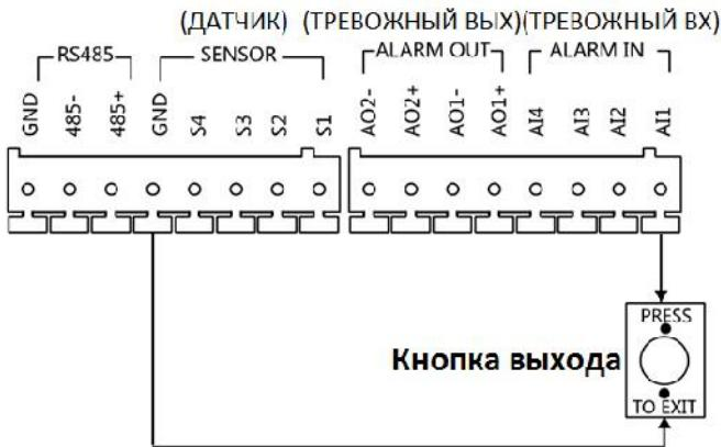
Рисунок 5-20 Подключение кнопки выхода для моделей DS-KD8102-V/DS-KD8002-VM (1)
