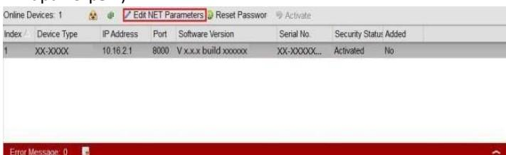
Рисунок 8-2 Изменение сетевых параметров
