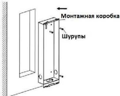
Рисунок 5-3 Установка монтажной коробки в стену
