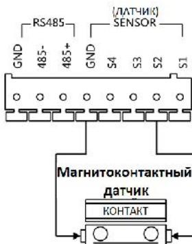
Рисунок 5-18 Подключение магнитоконтактного датчика для моделей DS-KD8102-V/DS-KD8002-VM (2)
