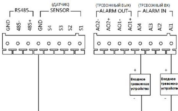
Рисунок 5-24 Подключение входов тревожных устройств для DS-KD8102-V/DS-KD8002-VM
