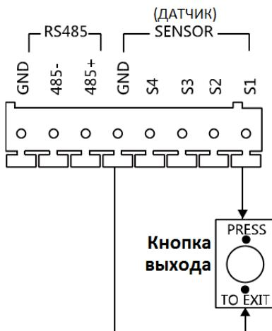
Рисунок 5-21 Подключение кнопки выхода для моделей DS-KD8102-V/DS-KD8002-VM (2)
