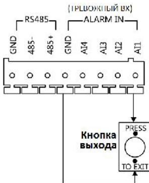
Рисунок 5-22 Подключение кнопки выхода для модели DS-KD6002-VM
