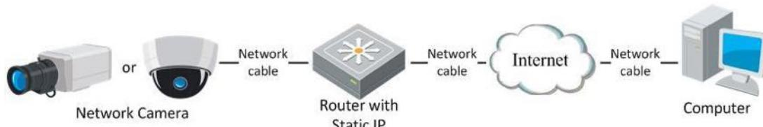
Рисунок 2-4 Доступ к видеокамере через роутер со статическим IP- адресом
