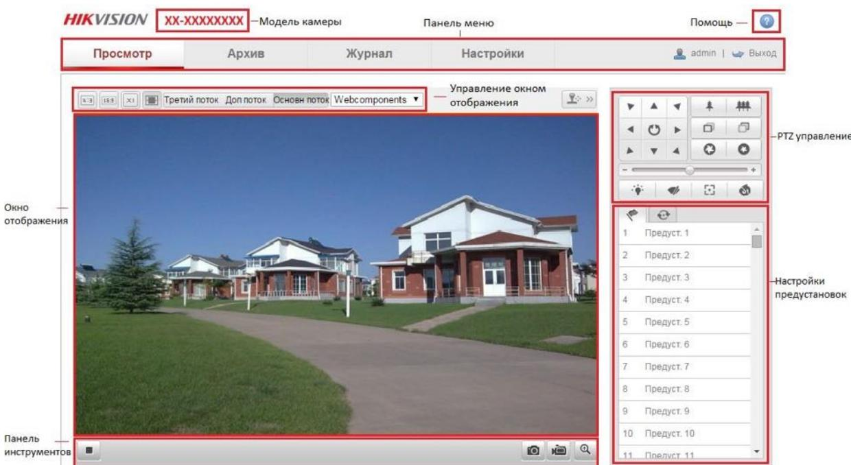
Рисунок 5-1 Интерфейс отображения
