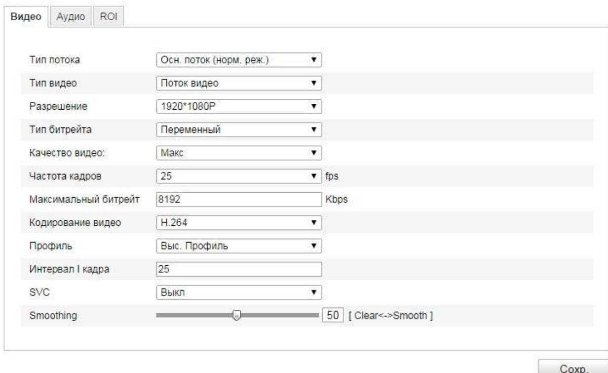
Рисунок 6-20 Настройка параметров видео
