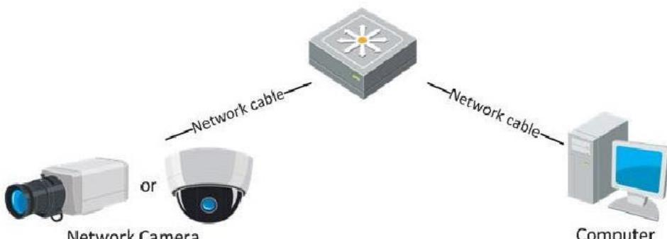
Рисунок 2-2 Подключение через коммутатор или роутер
