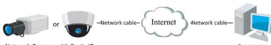
Рисунок 2-5 Доступ напрямую к видеокамере со статическим IP адресом
