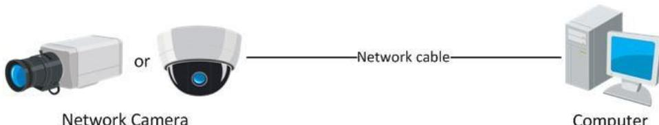
Рисунок 2-1 Подключение напрямую
