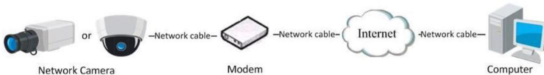
Рисунок 2-6 Доступ к видеокамере с динамическим IP адресом
